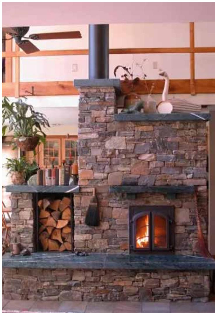
Las estufas de alto rendimiento, comúnmente llamadas estufas rusas, son artefactos de calefacción construidos de ladrillos refractarios, que se caracterizan por tener excelentes rendimientos. Los distintos ensayos que se han llevado a cabo en el INTA, arrojan rendimientos de entre el 84 y el 93 %, muy superiores a cualquiera de las otras estufas comunes.
